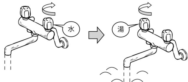
2バルブタイプの湯水混合栓を使用した後は、必ず湯側を先に閉める。（再度、湯水混合栓を使用する際にお湯が出て、やけどをすることがあります）
