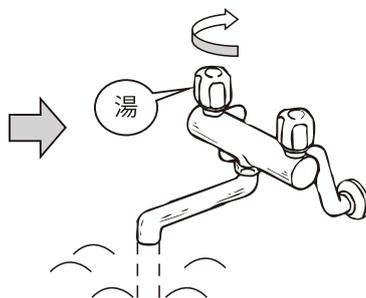
2バルブタイプの湯水混合栓を使用した後は、必ず湯側を先に閉める。
