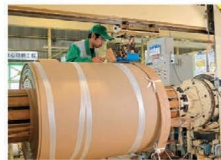
大型変圧器巻線工程
