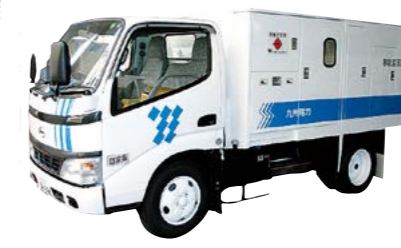
移動変圧器 Mobile transformer
