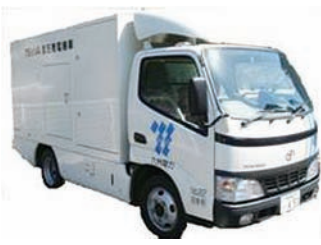
発電機車 Power generation truck
