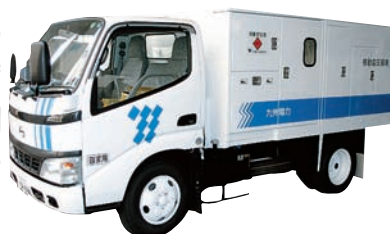
移動変圧器 Mobile transformer
