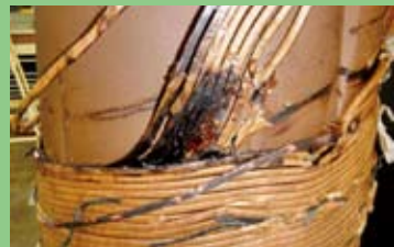
放電によるコイルの焼損・変形
