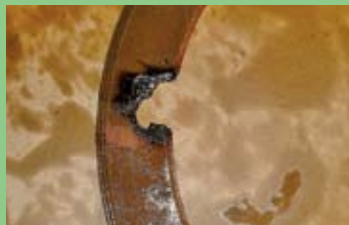
放電によるコイルの焼損・変形
