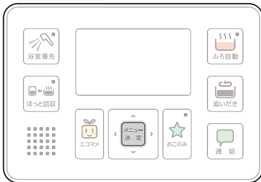
浴室リモコン
